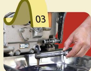
ถ่ายน้ำมันหล่อลื่นเก่าที่อยู่ในถังน้ำมันออกให้หมดแล้วนำใส่กรองน้ำมันหล่อลื่นออกมาล้างทำความสะอาดด้วยน้ำมันดีเซลแล้วใส่กลับเข้าที่เดิม จากนั้นเติมน้ำมันหล่อลื่น (ใหม่) เบอร์ 40 ที่ใช้สำหรับเครื่องยนต์ดีเซลลงไปให้ได้ระดับ
