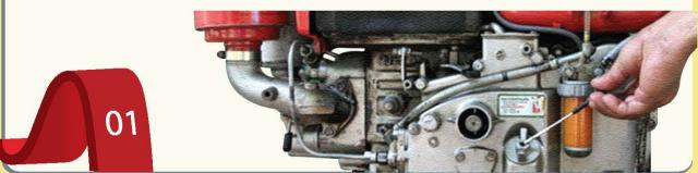
ตรวจสอบระดับน้ำมันหล่อลื่นในหม้อกรองอากาศให้ได้ระดับที่กำหนด ถ้าไม่ได้ระดับให้เติม จนได้ระดับ
