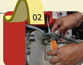
ถอดถ้วยกรองและใส่กรองน้ำมัน เชือเพลิงออกมาล้างทำความสะอาดด้วยน้ำมันดีเซล หากพบว่าใส่กรองอุดตันหรือมีข้าดต้องเปลี่ยนใหม่
