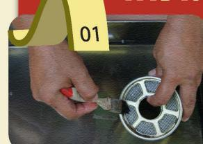
ถอดหม้อกรองอากาศออกจากเครื่องยนต์แล้วทำความสะอาดด้วยน้ำมันดีเซลแล้วเติมน้ำมันหล่อลื่น (ใหม่) เบอร์ 40 ที่ใช้สำหรับเครื่องยนต์ดีเซลลงไปในหม้อกรองอากาศให้ได้ระดับ
