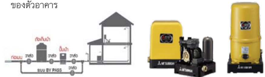
ภาพที่ 3.10 ติดตั้งปั๊มน้ำร่วมกับถังเก็บน้ำ ภาพที่ 3.11 ปั๊มน้ำแบบแรงดันคงที่ ที่มา: https://www.scgbuildingmaterials.com/th/HomeConsult/Blog/new-home
