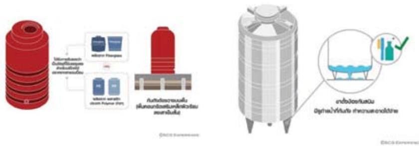
ภาพที่ 3.6 ถังเก็บน้ำพลาสติกที่ติดตั้งบนดิน ภาพที่ 3.7 ถังเก็บน้ำสแตนเลสที่ติดตั้งบนดิน
