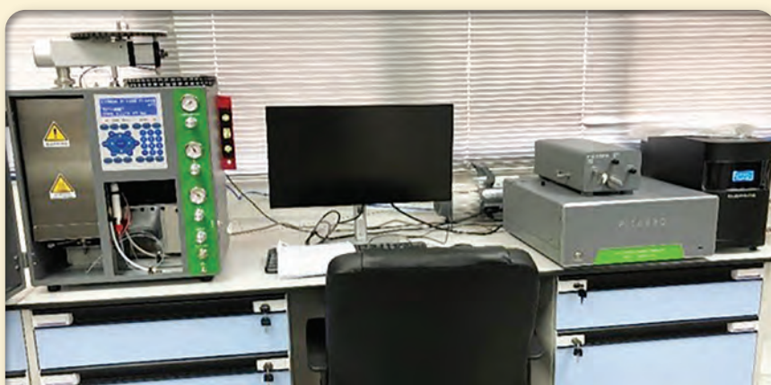
เครื่อง Combustion modules-cavity ring-down spectroscopy (CM-CRDS) สำหรับใช้ตรวจวิเคราะห์หาการปลอมปนน้ำตาลในน้ำผึ้งด้วยเทคนิคไอโซโทปเสถียร
