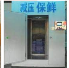
การเก็บรักษามะม่วงโดยใช้ตู้ความดันบรรยากาศต่ำ 5
