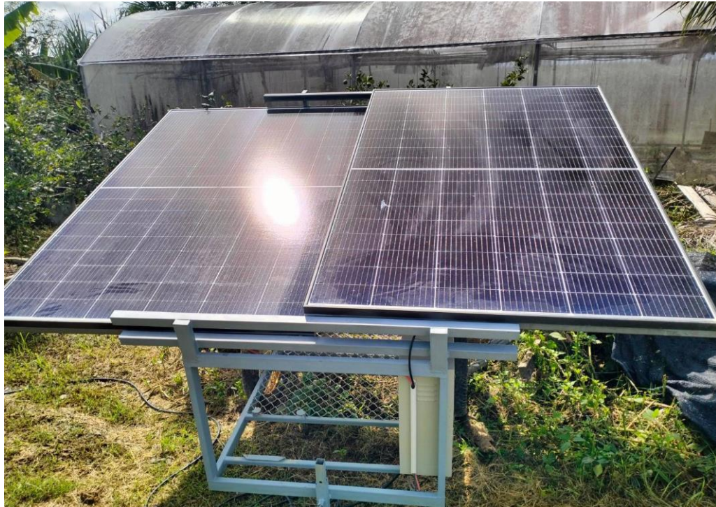
ภาพที่ 7 ระบบสูบน้ำพลังงานแสงอาทิตย์ แบบเคลื่อนที่
