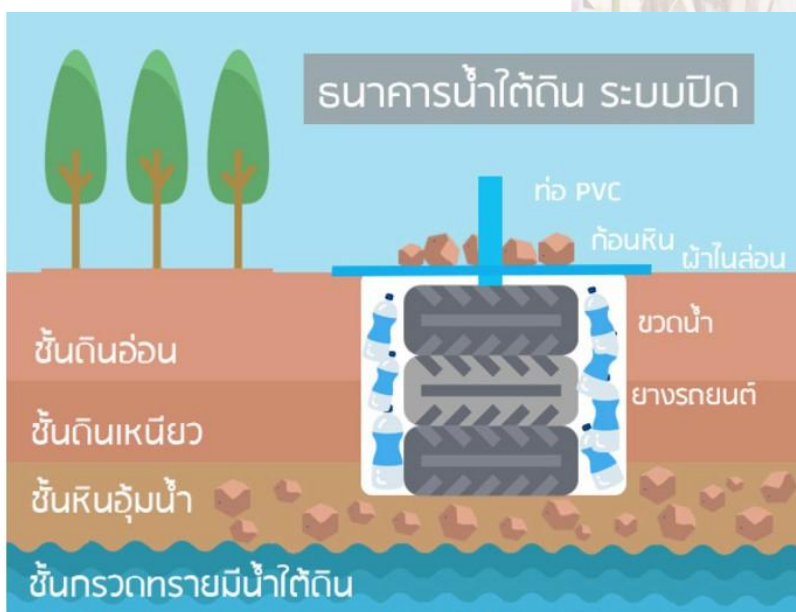
ภาพที่ 1 การขุดบ่อเพื่อทำธนาคารน้ำใต้ดินระบบปิด
