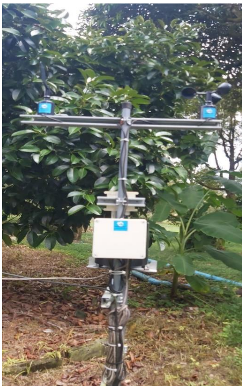
ภาพที่ 4 เครื่องตรวจวัดอุณหภูมิและความชื้นในดินและอากาศ
